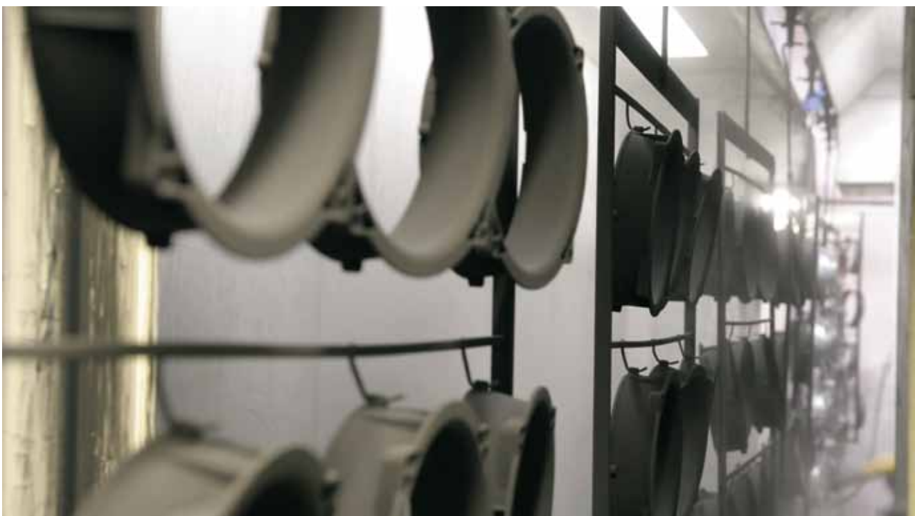
Bei ebm-papst werden die Teile zuerst manuell und anschliessend automatisch beschichtet.
