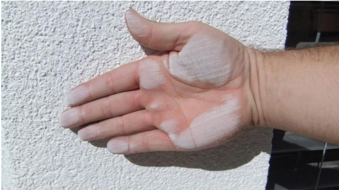
Bevor eine Rissanierung angebracht wird, soll vorgängig immer ein Haftabrissversuch gemacht werden, um die Tragfestigkeit des Untergrundes zu prüfen.
