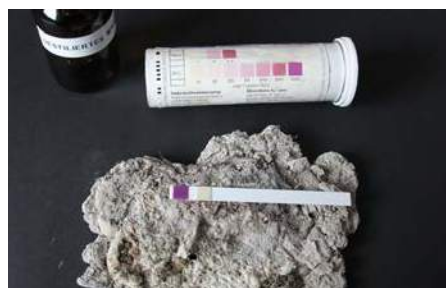
Analyse bauschädliche Salze
