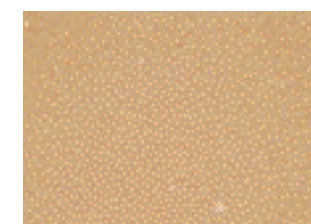
Standard-Pulverlack mit Entgasungsadditiv, von Hand eingerührt, 6,5-fach vergrössert
