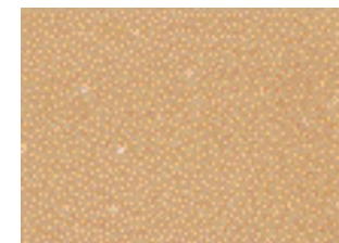
Standard-Pulverlack 6,5-fach vergrössert
